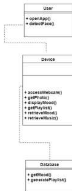
Фиг. 5.9 Диаграма на класовете на мобилно приложение за разпознаване на настроение и генериране на музикален плейлист.
